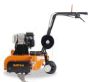
Mobilní stroj na zářezové pokládání kabelů ELIET Edge Styler Plus
