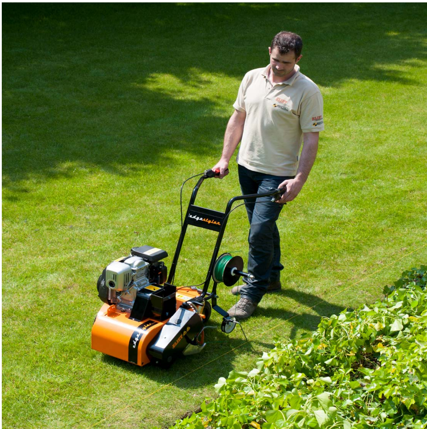
Mobilní stroj na zářezové pokládání kabelů ELIET Edge Styler Plus
